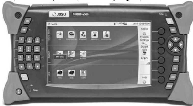
Rysunek 6: Reflektometr optyczny OTDR [7]
